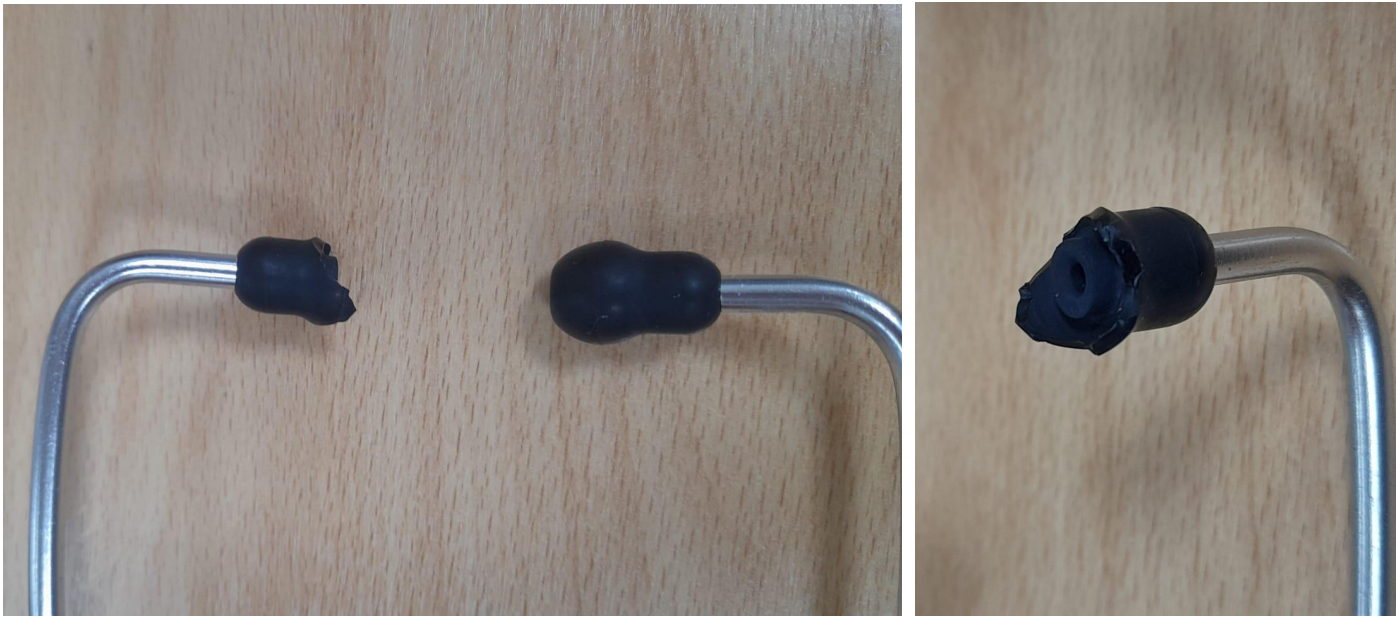
Figura 3. Auricular con pieza plástica protectora rota
