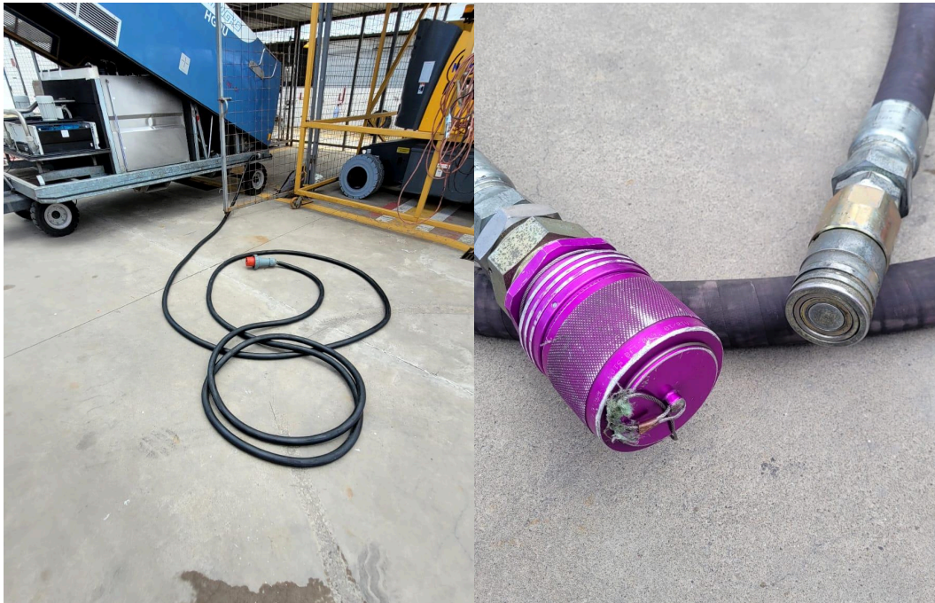
Fotografía 7. Inspección y limpieza de mangueras.
