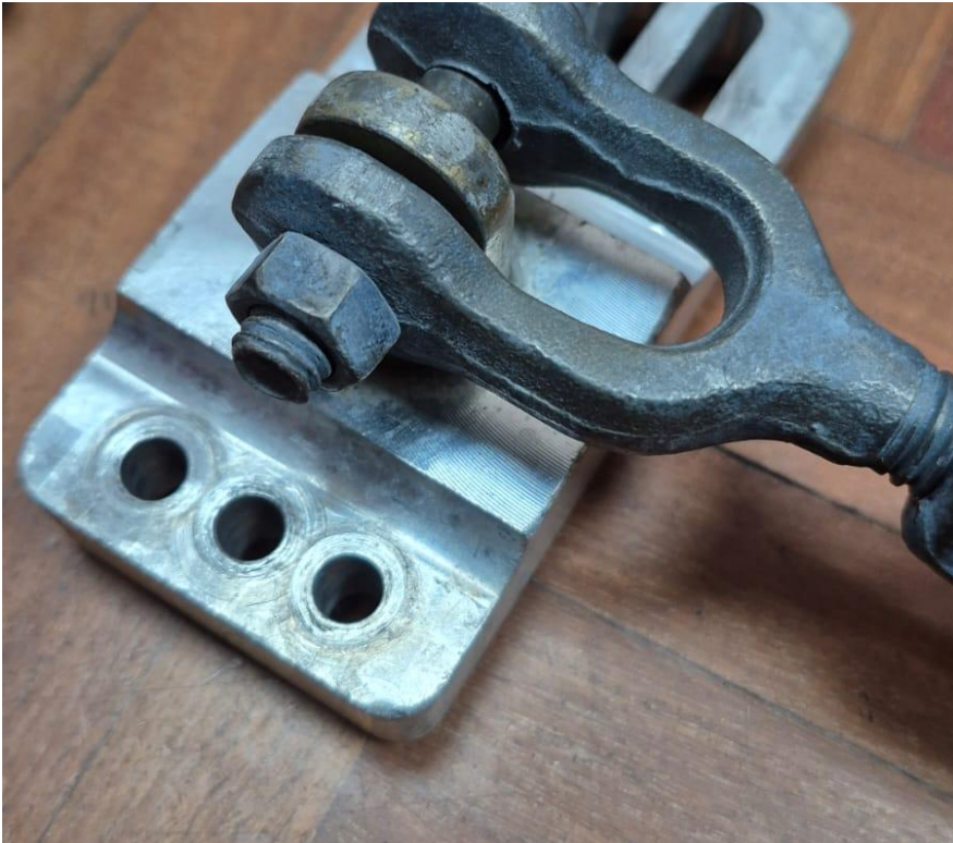
Figura 1. Vista de un punto de anclaje.
