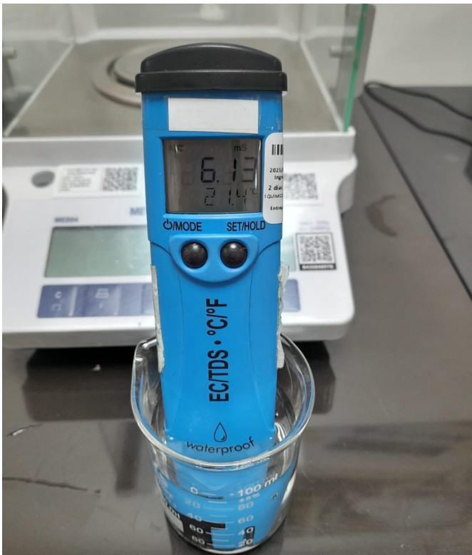
Figura 2. Lectura incorrecta en solución patrón de 12.88 µS/cm.
