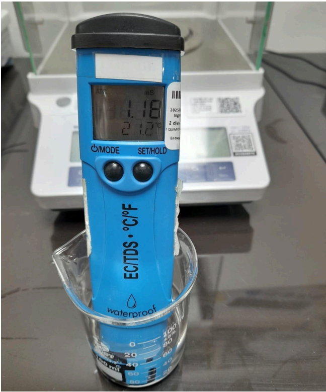
Figura 1. Lectura relativamente correcta en solución patrón de 1314 µS/cm
