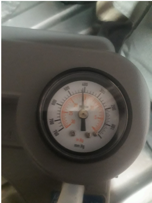
Figura 3. Manómetro en buen estado y funcionando correctamente
