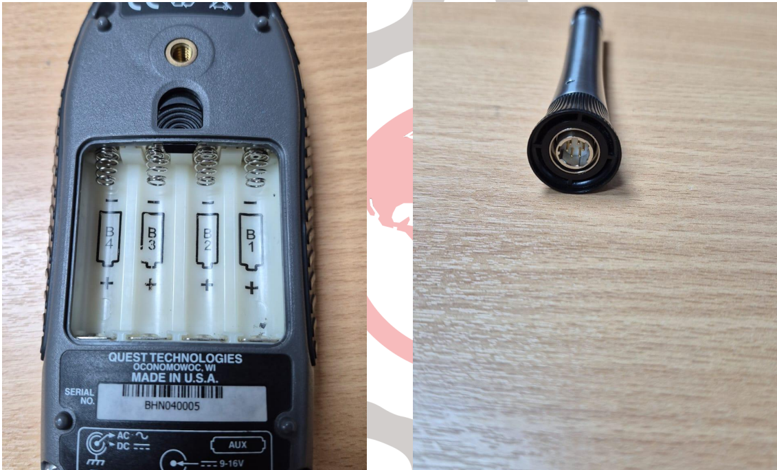
Figura 2. Puerto de baterías y vista del puerto de conexión del sensor.
