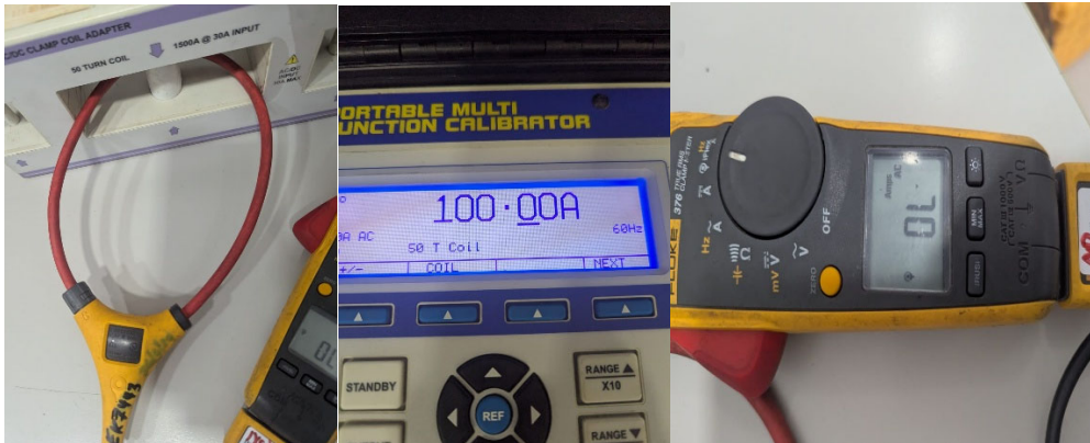
Fig 1 Prueba del equipo @100 A, no se registra el valor esperado
