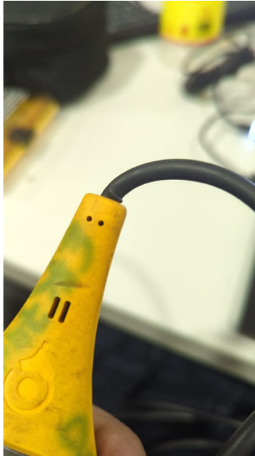
Fig 2. Posible Punto de quiebre del cable de conexión al lector
