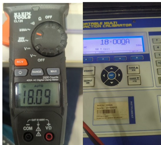
Fig 2. Prueba medición de corriente, rango 20AAC @18AAC
