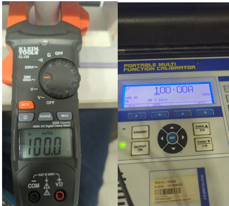
Fig. 3 Prueba medición de corriente Rango 400AAC @100AAC
