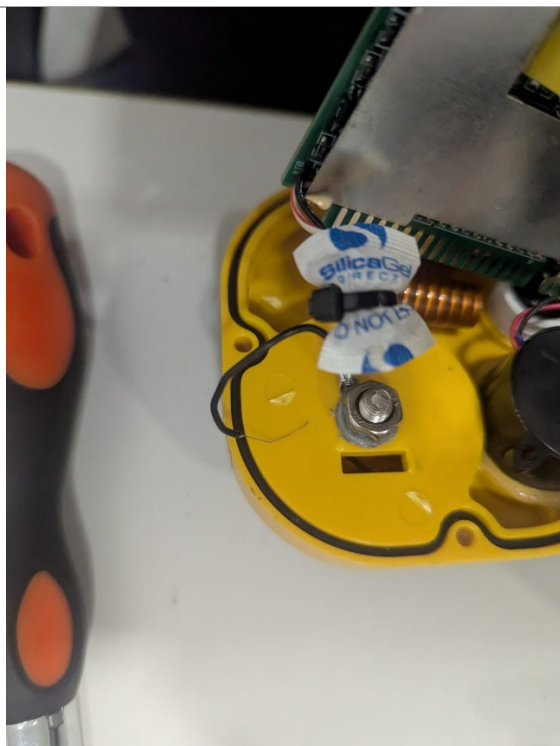
Fig 1 Cable suelto, se trata del cable a terminal negativo de la batería
