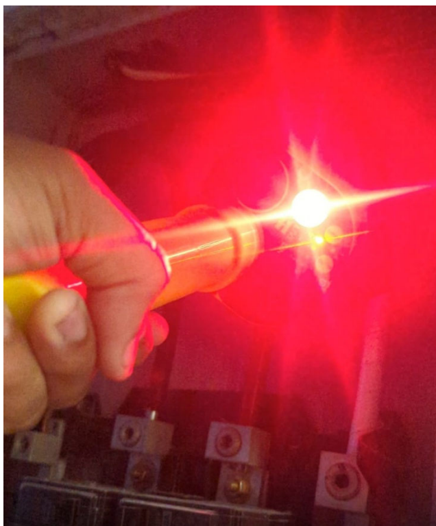
Fig 2. Prueba de detección de voltaje realizada con éxito
