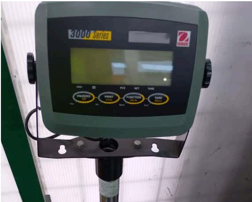
Figura 1. Equipo apagado debido a su batería interna.
