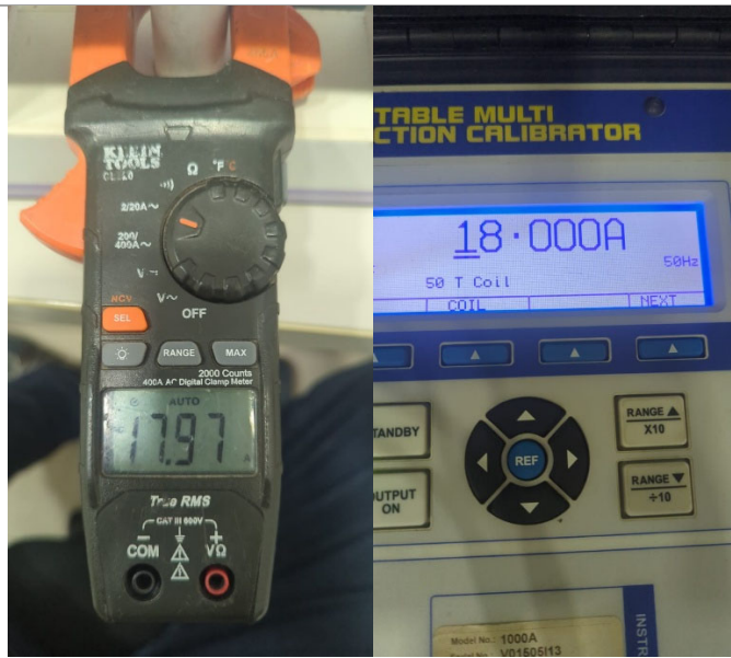
Fig. 3 Prueba medición de corriente Rango 20AAC @18AAC
