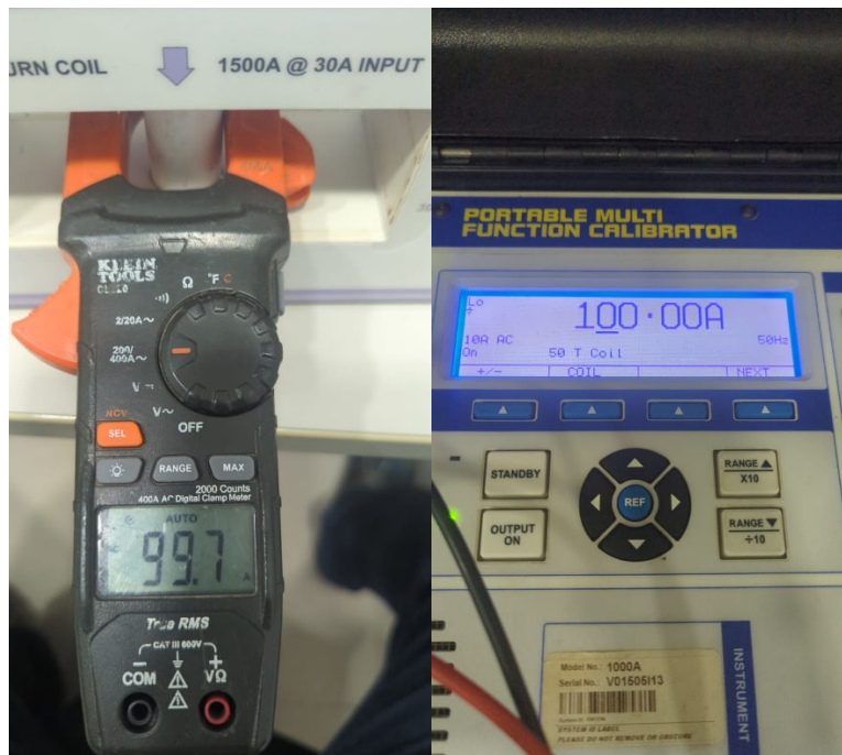
Fig 4 Prueba medición de corriente rango 400AAC @ 100AAC
