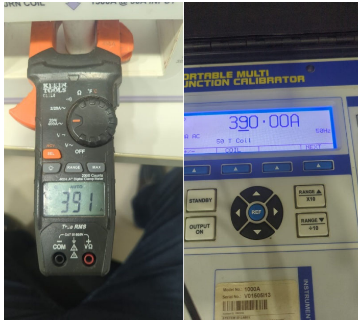
Fig. 5 Prueba medición de corriente rango 400AAC @ 390AAC
