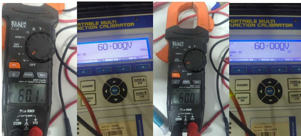
Fig. 6 Prueba de voltaje AC/DC @ 60V
