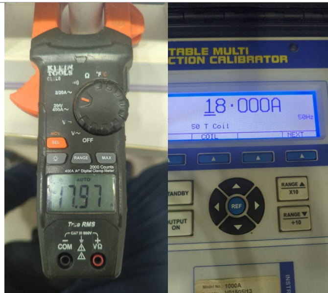
Fig. 3 Prueba medición de corriente Rango 20AAC @18AAC
