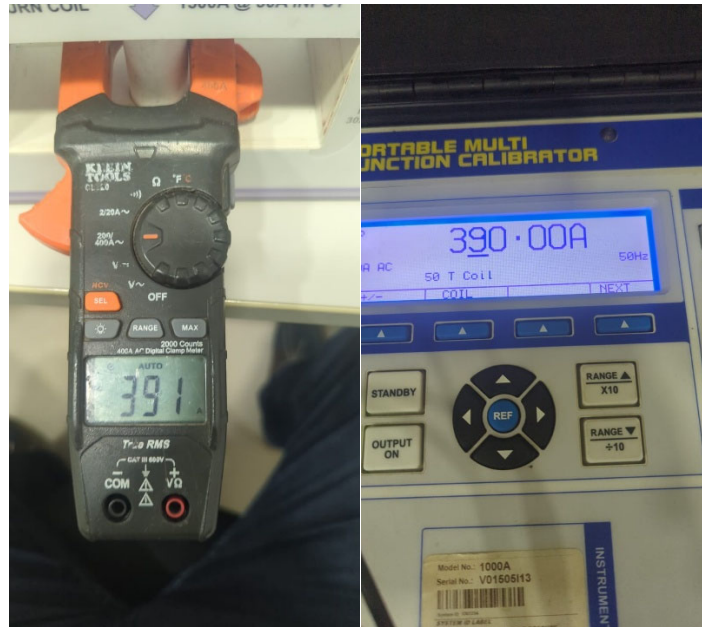
Fig. 5 Prueba medición de corriente rango 400AAC @ 390AAC
