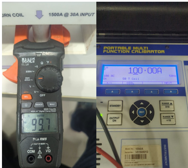
Fig 4 Prueba medición de corriente rango 400AAC @ 100AAC
