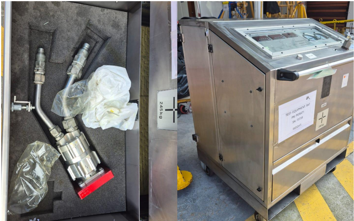
Fotografía 3. Cajón sin presencia de fugas.
