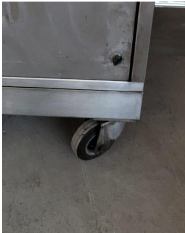
Fotografía 6. Revisión de daño en frenos del equipo.
