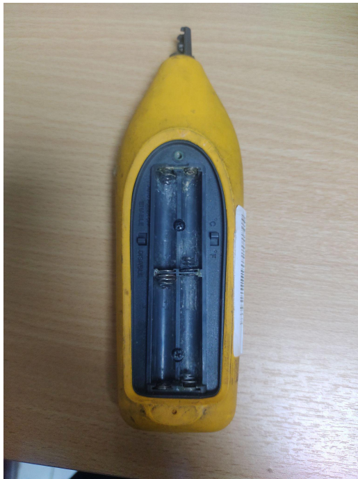
Presencia de óxido en el compartimento de Baterías
