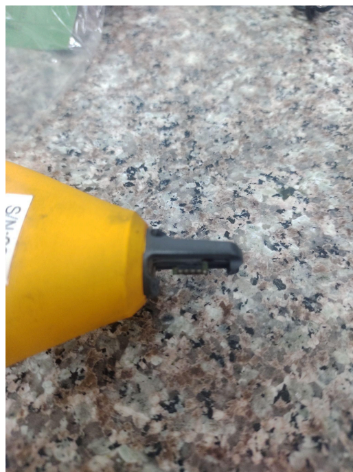
Plástico que recubre los sensores se encuentra roto
