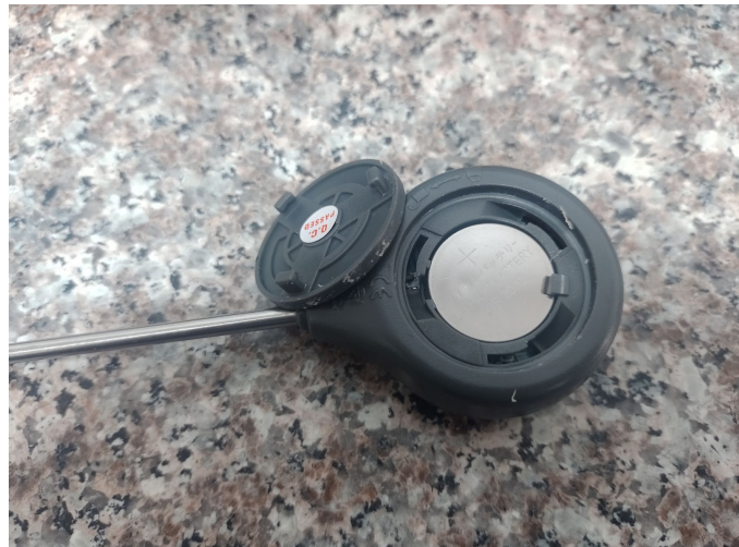
Figura 1. Presencia de suciedad en la tapa de la Pila
