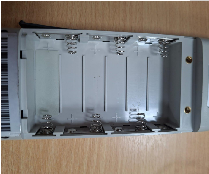
Fig. 2: Componente eléctrico, sin sulfatación
