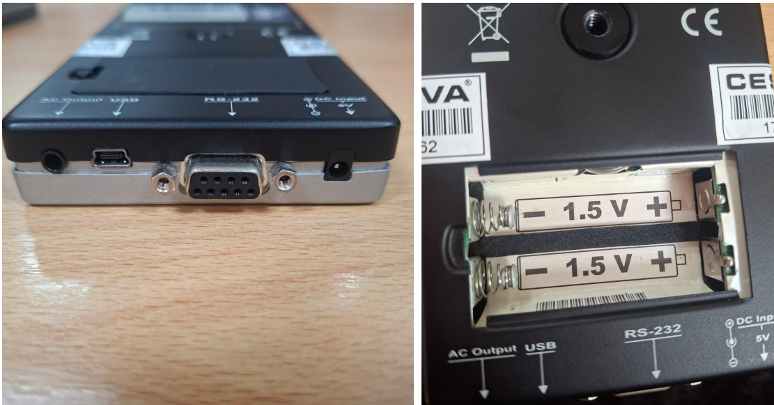
Figura 2. Puerto de baterías y vista del puerto de conexión del sensor.
