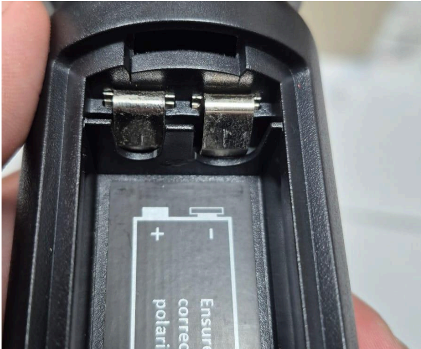
Figura 1. Estado de los bornes de la batería.
