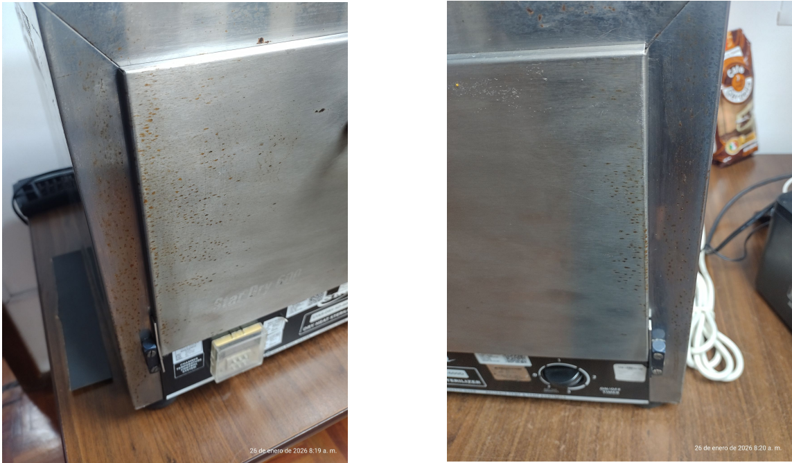
Figura 1. Presencia de óxido el la carcasa y tapa del equipo
