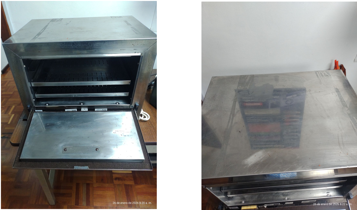
Figura 2. Presencia de suciedad el la carcasa y buen estado del interior del equipo
