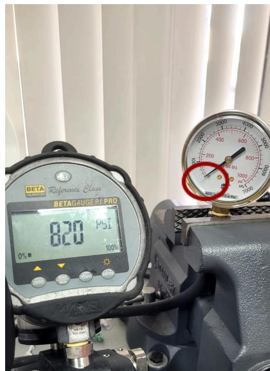
Figura 1: Prueba del equipo sin líquido hidráulico.
