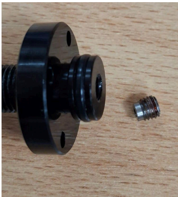
Fig. 3: Presencia de óxido y grasa acumulada antes de mantenimiento
