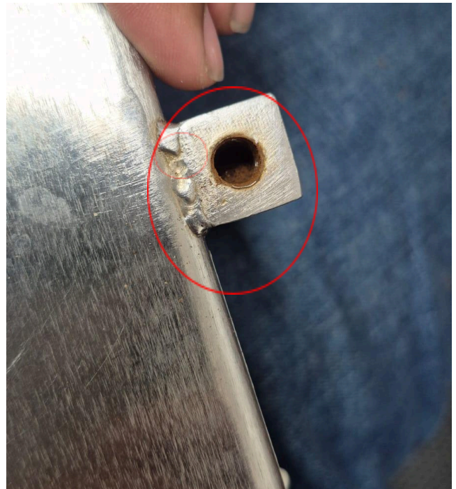
Figura 2: Oxidación dentro donde se ubica el resorte.
