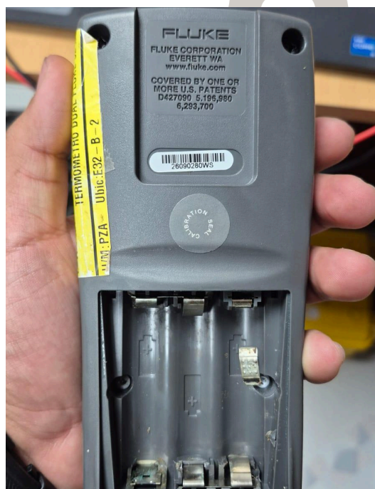
Figura 2. Sección con daño.
