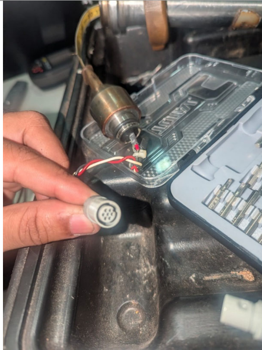
Fig 3. Conector del sensor en buen estado
