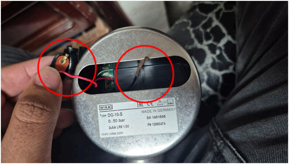
Figura 1: Compartimiento de pilas desoldada.
