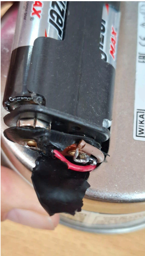
Figura 3: Soldadura compartimento de baterías.
