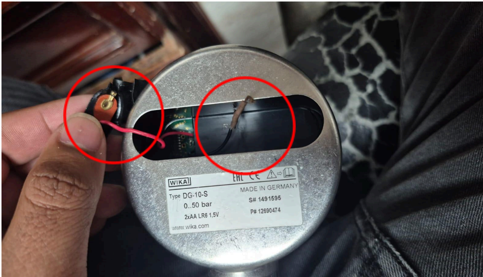
Figura 1: Compartimiento de pilas desoldada.
