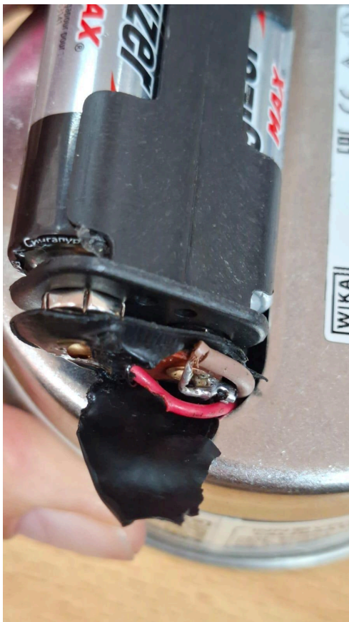
Figura 3: Soldadura compartimiento de baterías.
