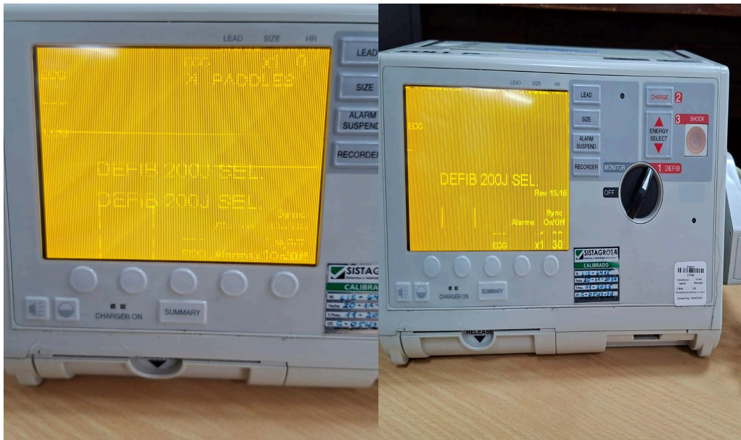
Figura 1. Condición inicial del equipo, donde se evidencia falla en la visualización de la pantalla, presentando distorsión y líneas que afectan la correcta lectura de la información.
