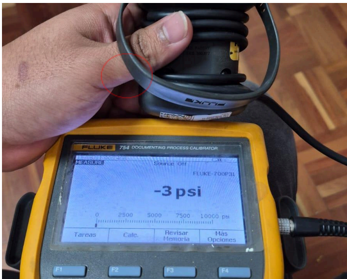
Figura 3: Prueba con el mismo modelo y conexión con Fluke 754.
