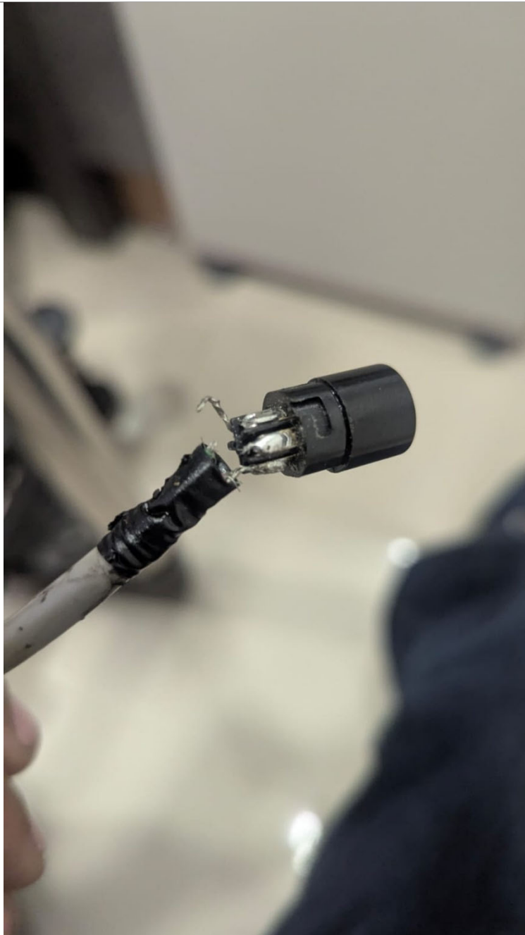
Fig 1 Conector completamente desoldado
