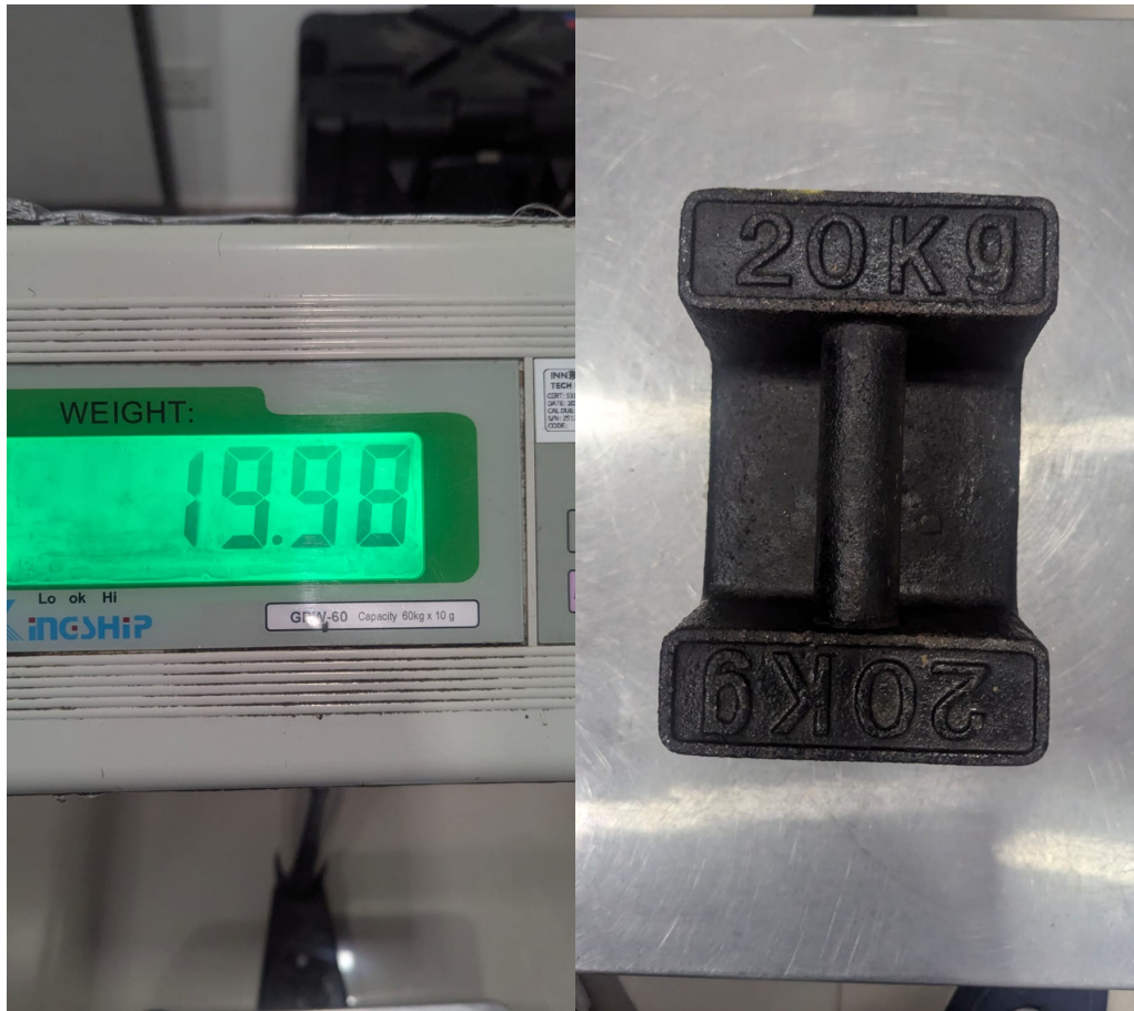
Fig 3. Prueba de funcionamiento de la celda de peso, como se muestra el resultado es satisfactorio
