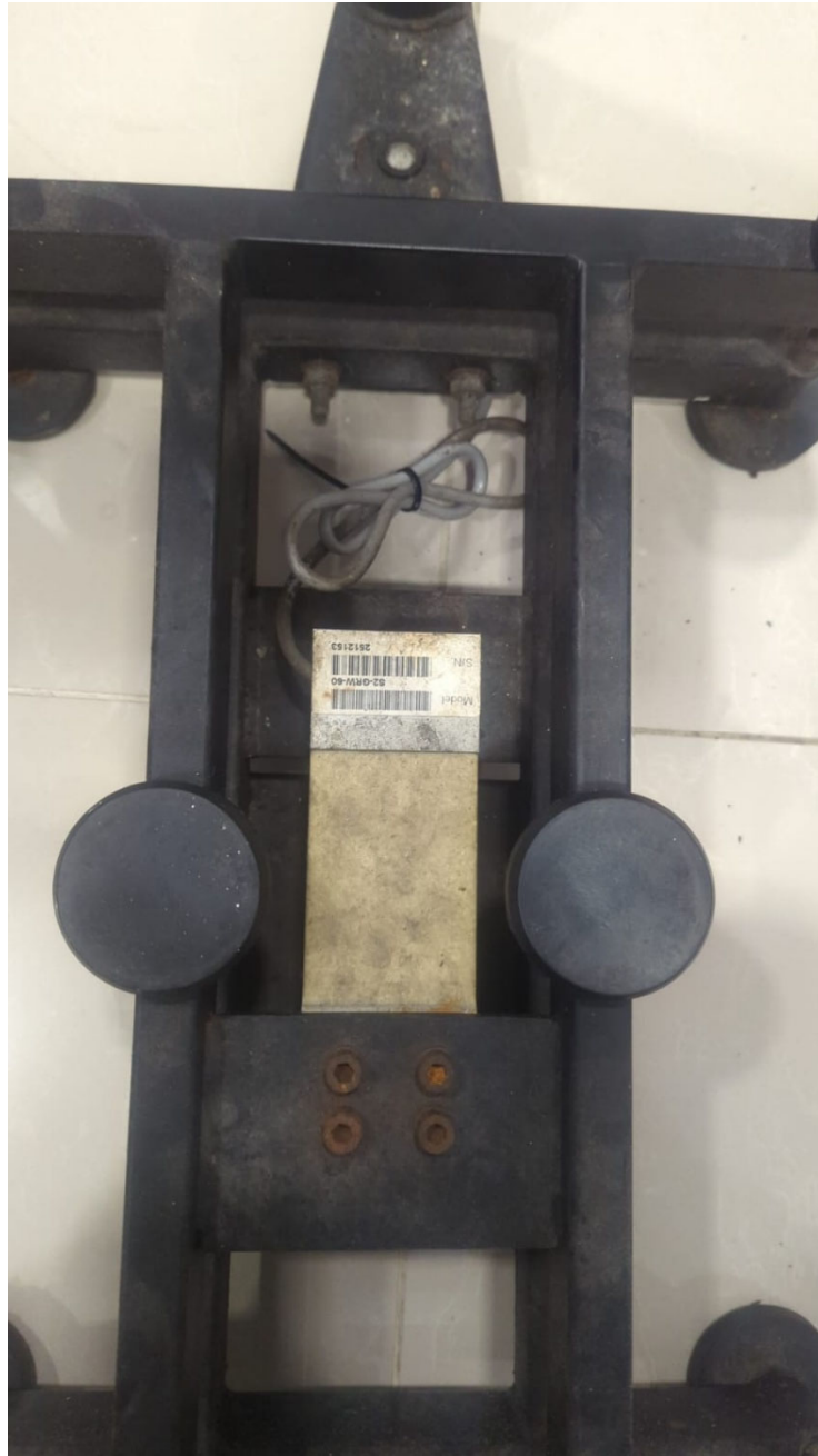
Fig 2 Mecanismo de celda de peso, se recoge el cable en esta parte para evitar
